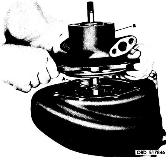
FIGURE 44. POSITIONING BEARING HOUSING ON TURBINE HOUSING - TURBOCHARGERS 7748900 AND 10935279.
